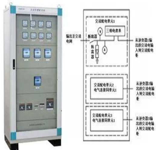
a) 交流配电柜外观 b) 交流配电柜电气连接图 图2-20 交流配电柜外观和电气连接图
